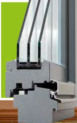
Im Standard werden die Fenster im IV 78-Profil gefertigt. Optional wird eine Holz-/Alu-Vorsatzschale für Blendrahmen und Flügel auf der Wetterseite angeboten. Alle Eckverbindungen der Aluschale werden verschweißt; die Schalung wird gem. Farbkarte pulverbeschichtet oder eloxiert.
