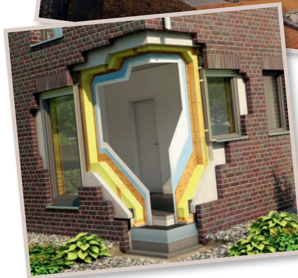
Ein Blick in die Wand offenbart den komplexen Aufbau aus mehreren Schichten: Gut zu erkennen ist die dicke Dämmschicht zwischen dem Holzständerwerk.
